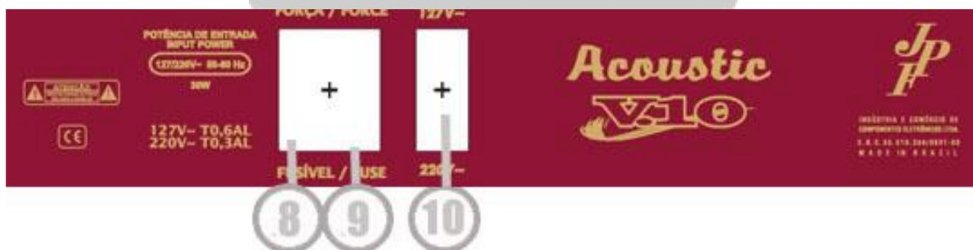
08. **Força** –conector para cabo de força do amplificador;
