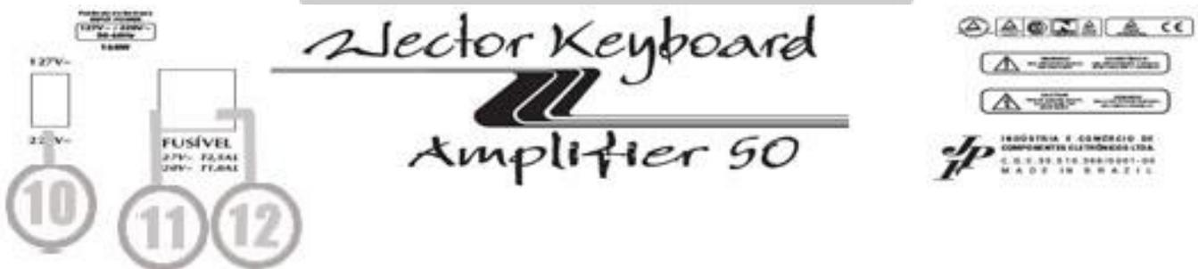
10. **127v~240v** – Chave seletora de voltagem para ajuste de voltagem em 127 ou 240 v;
